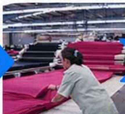
TENDIDO DE TELA Revisión Defectos de tela
